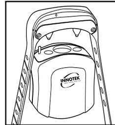
doit y être inséré avec les contacts tournés vers le bas à travers les trous correspondants. Un circuit de sécurité intégré empêche toute surcharge du dispositif. Le témoin lumineux du collier est rouge lorsque ce dernier est correctement placé et en charge ; il vire au vert une fois le chargement terminé.
