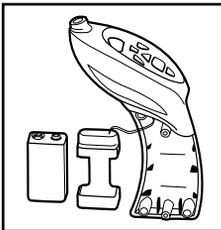
La pile de 9V s'insère dans un manchon de protection pour améliorer l'étanchéité. Pliez l'ensemble avec précaution et remplacez-le dans la poignée de la télécommande.
